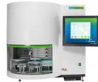
Las técnicas moleculares utilizadas fueron RTqPCR(14985) y Amplificación Isotérmica (AI) (690). La primera amplifica las regiones del virus que corresponden al gen E, N y al RDRp; en dos termocicladores COBAS-Z480-ROCHE.
